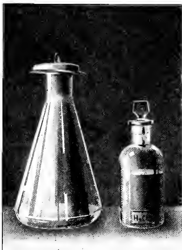
FIG. 23. Simple form of Gutzeit apparatus
